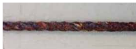
Traditioneel verzinkt anker na 500 uur zoutsproeitest
