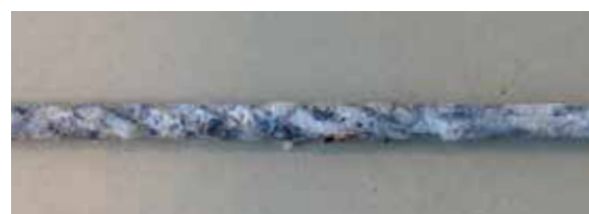
Dualfix Durable anker na 500 uur zoutsproeitest
